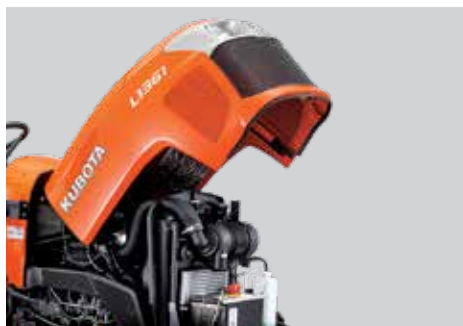
Vysúvacia mriežka chladiča / Kapota otváraná teleskopickou vzperou
