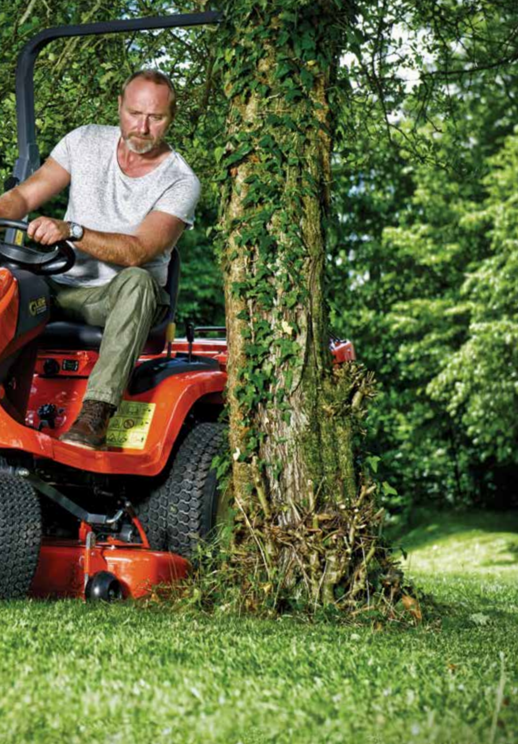
Nastavenie výšky rezu na žacím mechanizme - centrálne a ľahko zo sedadla
