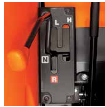
Páka radenia stupňov 2 stupne, späť
