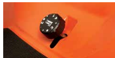
Nastavenie výšky rezu na žacím mechanizme - centrálne a ľahko zo sedadla
