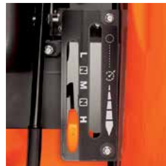
Páka radenia a systém udržiavania rýchlosti
