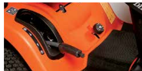
Zdvihnutie žacieho mechanizmu s podporou tlaku plynu
